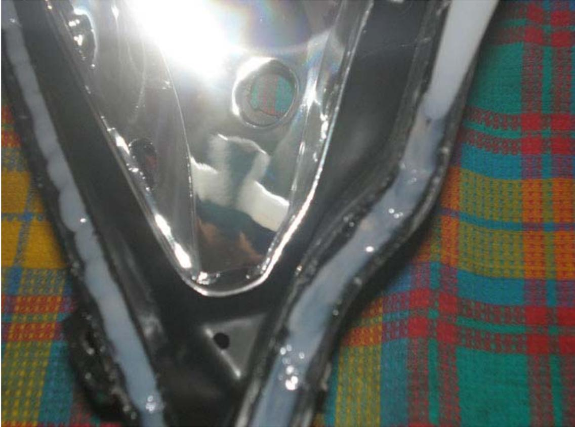
28) стекло фары ставим на место с нажимом со стороны дальнего потом ближнего блоков, проверяем швы чтобы не было щелей, если что - герметиком снаружи и оставляем на 2-3 часа чтоб герметик застыл. Вставляем лампы и тащим фары в гараж. Сборка в обратной последовательности. ВОТ пожалуй и все. Удачи в переделки. Да, после установки надо бы фары подрегулировать.
