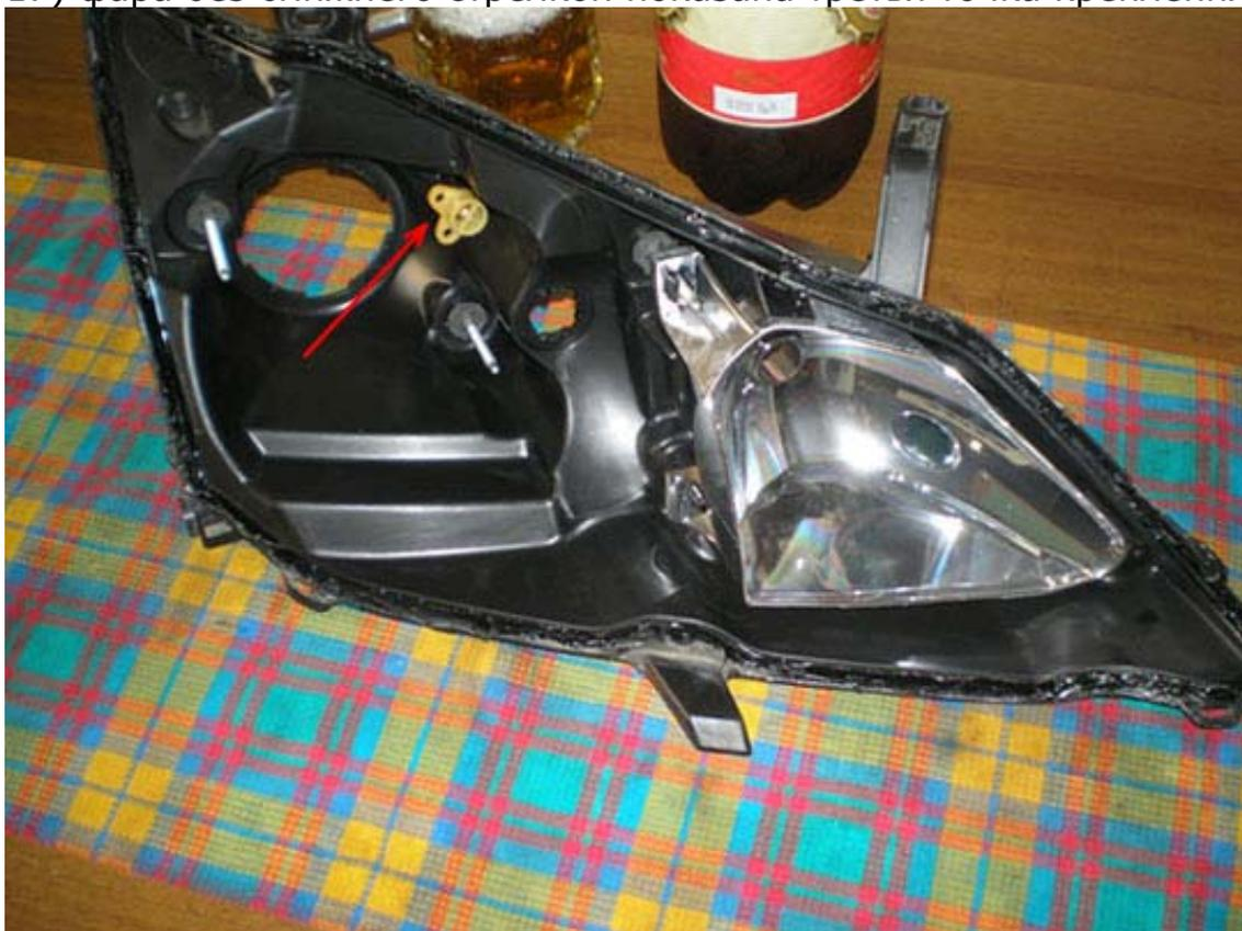
18) снимаем линзы, они защелкиваются тоже в 3х точках - одна вверху и 2 внизу
