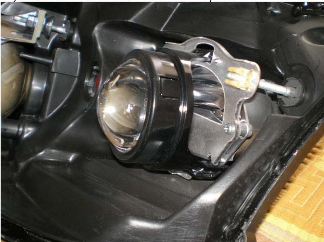
15) надо бы его открутить, крепится в 3х точках, снаружи 2 регулировочных винта и внутри подвижная пластиковая штука на 2х винтиках
