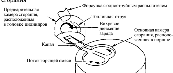
Дизельный двигатель с разделенной камерой сгорания
